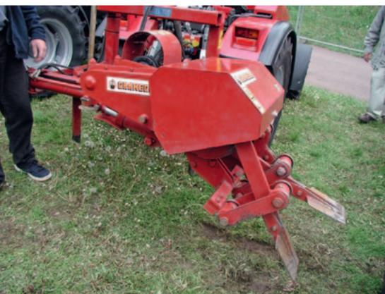
Erdbohrer (Abb 3). Damit kann gleich nach dem Entfernen eines Stockes wieder ein neues Pflanzloch gebohrt werden.
