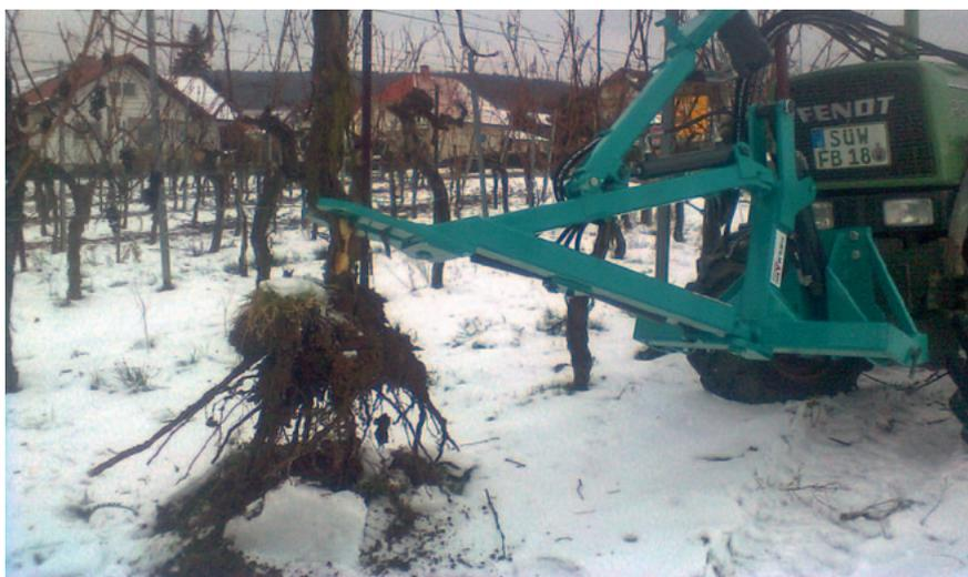
Abb. 3: Eine Rodezange kombiniert mit einem Erdbohrer (ESKA) kann nach dem Herausziehen des Stockes sogleich das Pflanzloch erstellen
