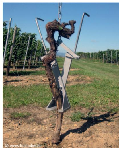
Abb. 4: Mechanische Rodezange zum Einhängen an einen Hubmast
