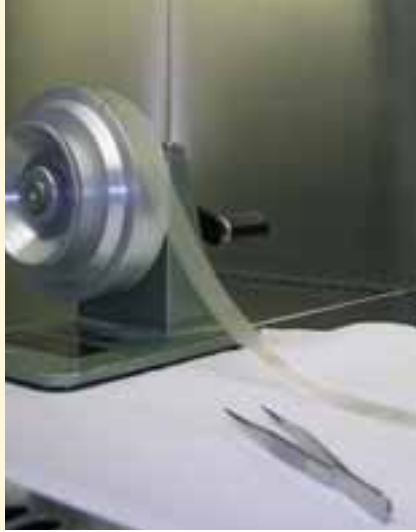
Fig. 79 - Tamburo e nastro su cui aderiscono le spore
