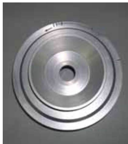
Fig. 78 - Tamburo del captaspore
