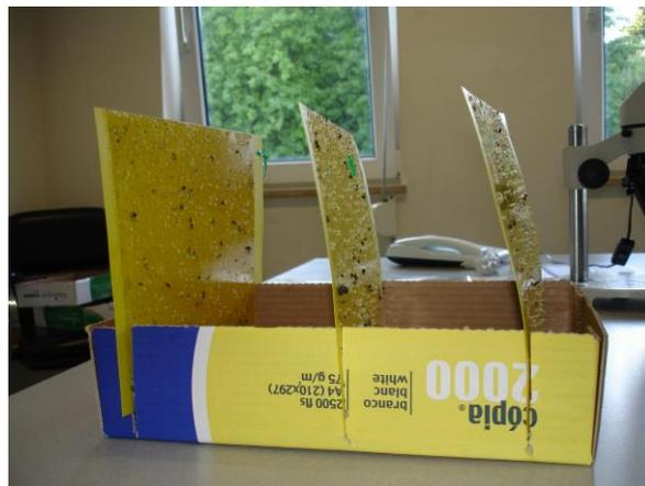
Exemplo 1: armadilhas devidamente identificadas e distanciadas de modo a não tocarem umas nas outras. Quando se tocam colam-se e, além de dificilmente se conseguirem descolar, danificam os insetos, inviabilizando a sua posterior identificação.
