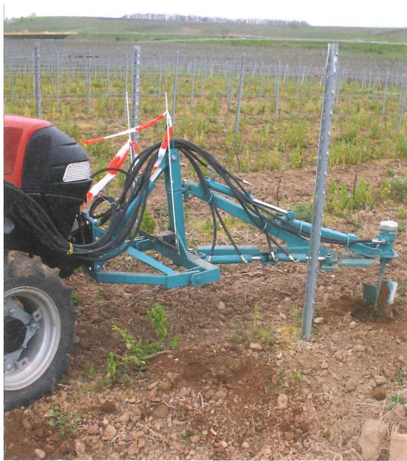
Abb. 6: Hydraulischer Erdbohrer an der Schlepperfront, kombiniert mit einer Rodezange
