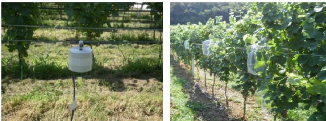
Figure 2. Shaker disegnato per trasmettere segnali di disturbo a più lunga distanza (Fonte: Lucchi et. al)
